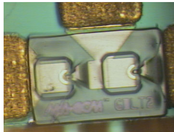
Structura modul receptor cu antena Yagi-Uda pentru 35GHz si detaliu cu dioda Schottky flip chip lipita pe structura de receptor
