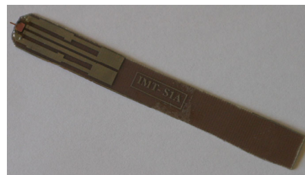
Microsonda montata pe un cablaj sub forma unui “stilou”
