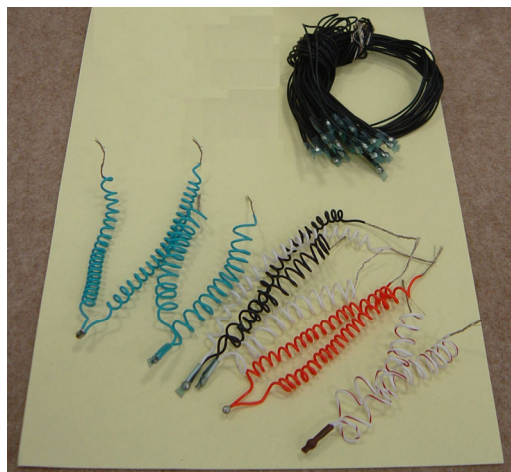
Poza pozistoare PTC cu terminale izolate în teflon, pentru tensiuni mari
